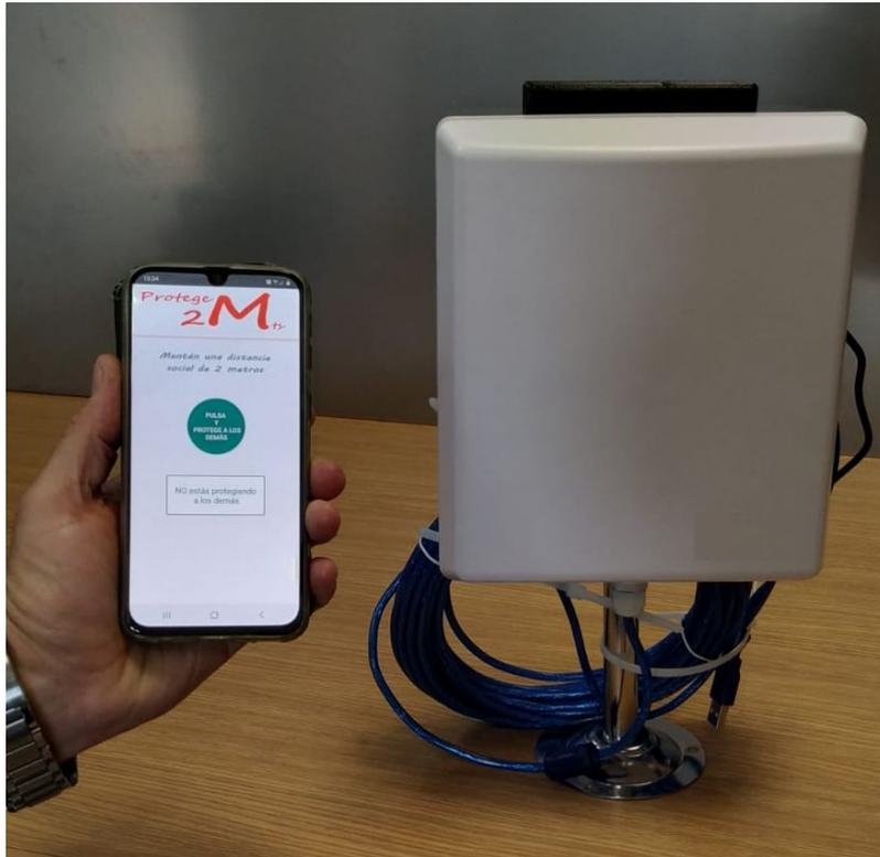
Figura 3. Sensor para la detección de smartphones.
