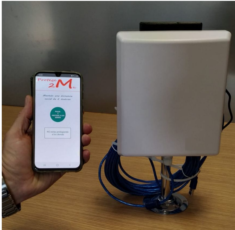
Figura 3. Sensor para la detección de smartphones.
