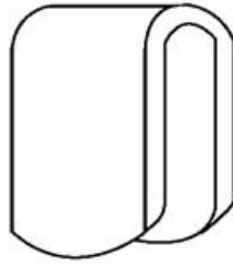
Figura 1. Pestaña para tapar la lente de las cámaras integradas en los dispositivos electrónicos
