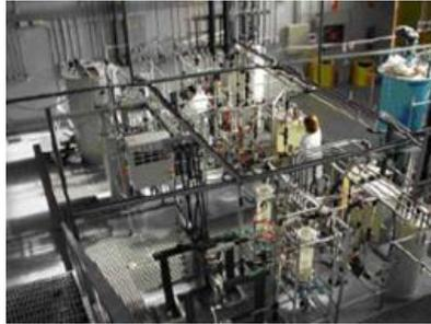
El grupo de investigación ha llevado a cabo la síntesis de varios productos a escala industrial piloto. Entre estos productos cabe destacar la síntesis electroquímica de 13.000 kg de S-carboximetil L-cisteína que ha sido sintetizada electroquímicamente en esta planta piloto con muy buenos resultados.
