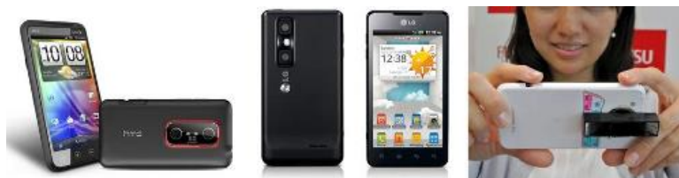
Figura 3. Modelos de teléfonos dotados con dos cámaras HTC Evo 3D (izquierda) y LG Optimus 3d (centro). Sistema catadióptrico de Fujitsu para obtener dos imágenes separadas con cualquier móvil (derecha).
